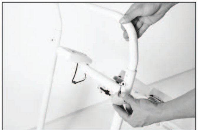
2. 프레임 고정 볼트 [핸들 쪽] (2개)를 풀어 빼준 후 핸들을 가장 낮은 높이로 조정한 후 다시 체결하여 조여 줍니다.
