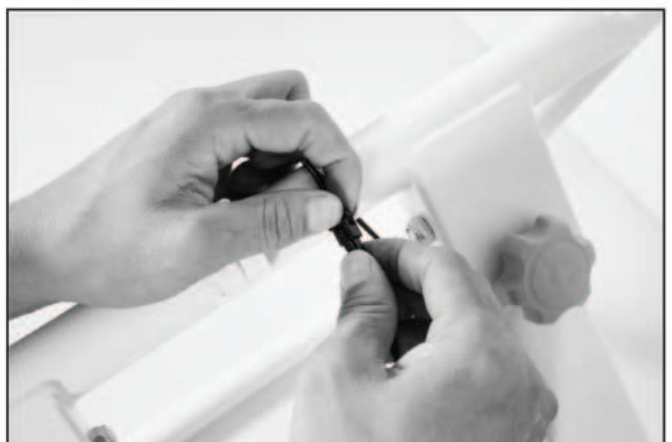
2. 프레임 고정 볼트 [핸들 쪽] (2개)를 풀어 빼준 후 핸들을 가장 낮은 높이로 조정한 후 다시 체결하여 조여 줍니다.
