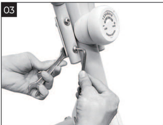
03 1, 2번과 같이 4부분을 모두 조립합니다. 튼튼하게 고정하기 위해 4부분 각각 L렌치를 이용하여 볼트를 잡고, 스패너를 이용하여 조여줍니다.
